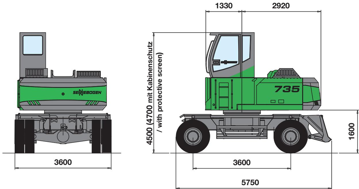
**735 M-HD** mit starr hochgesetzter Kabine, Erhöhung 1000 mm, mechanisch oder auf Wunsch hydraulisch nach vorne abklappbar.
